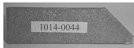
4. ábra Vídia betétes öntvény saroklapát wolfrám-karbid bevonattal
