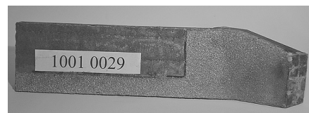
3. ábra Vídia betétes, kompozit saroklapát wolfrám-karbid bevonattal
